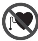
**No coloque el aparato de medición cerca de personas que utilicen un marcapasos.** El campo magnético que producen los imanes 4 puede perturbar el funcionamiento de los marcapasos.
